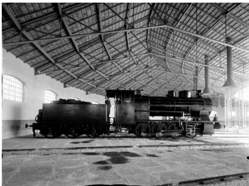
Locomotora vapor n.º 751 de MZA, con rodaje 040, fabricada por Maffei en 1907. Década 1910.
