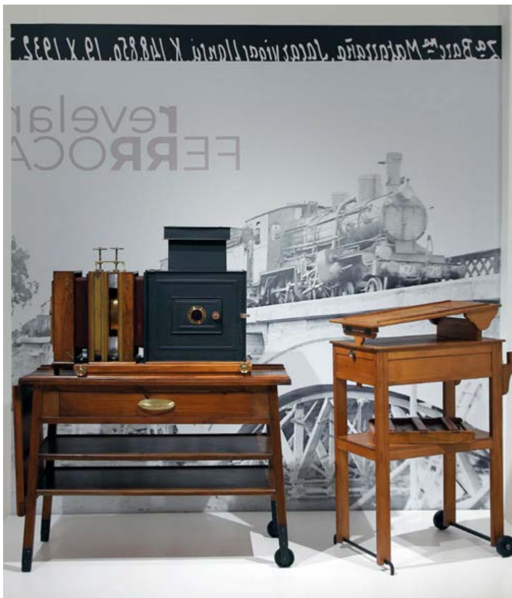
Amplificadora fotográfica y mesa auxiliar de la sección fotográfica de Vía y Obras.
