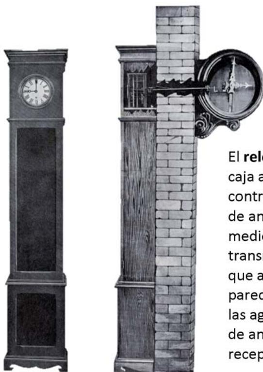
El **reloj patrón** (de caja alta) controlaba el reloj de andén por medio de una transmisión rígida, que atravesaba la pared y accionaba las agujas del reloj de andén o receptor.
