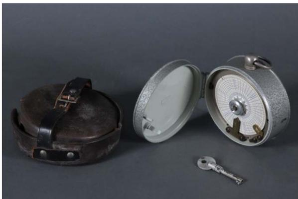
Permitía controlar que la ronda de vigilancia se había realizado en tiempo y forma. En distintos puntos del recorrido se encontraba fijada y sujeta con una cadena una llave que, al introducirla y girarla en el reloj, marcaba en una cinta o disco de papel el número de la dependencia y la hora. Un dispositivo especial en la tapa permitía identificar las aperturas no autorizadas del reloj, evitando que se pudiera manipular la hora.
