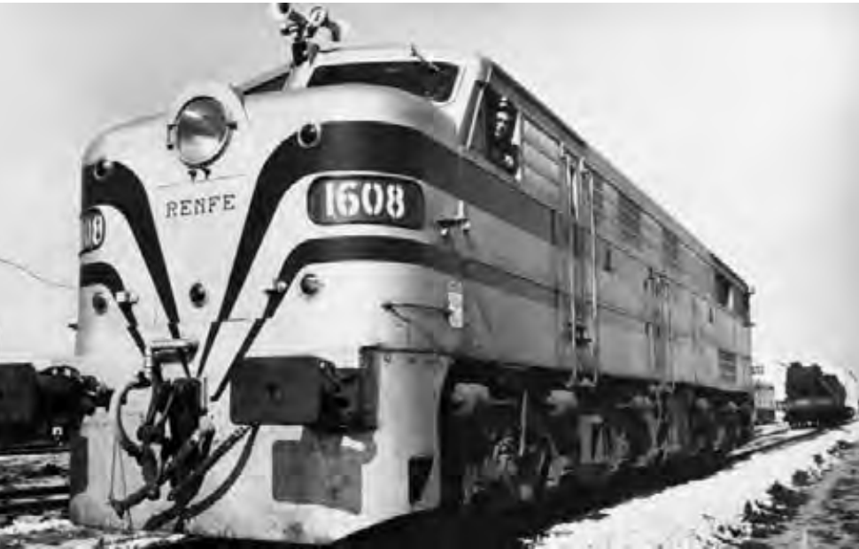
► Locomotora diésel eléctrica CoCo Alco de la serie 1600 de Renfe.
