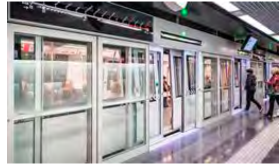
► Tren autónomo de la línea 9 del Metro de Barcelona en estación dotada de andén con puertas. Propietario: TMB (empresa pública explotadora del metro de Barcelona).
