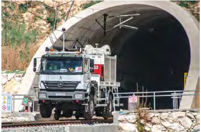
► El vehículo desarrollado por Tunnel Curiosity reduce el mantenimiento correctivo de los túneles en un 15%.
