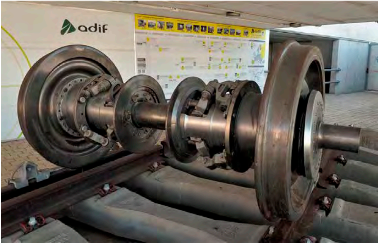
► El nuevo sistema evita suspender la carga de las ruedas durante el cambio.
