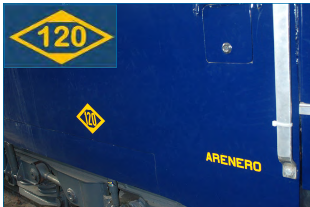
Figura 15. Portilla del arenero y tubo de vertido al carril de un tren TER. El rombo amarillo indica la velocidad máxima autorizada al tren. Foto: JAMP 02/05/2018
