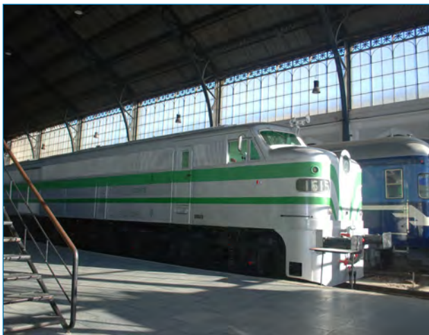
Figura 2. Locomotora diésel-eléctrica 1615 ALCO, “Marilyn”, con un motor diésel de 1600 CV conectado a un generador eléctrico que alimenta 6 motores ubicados uno en cada eje. Detrás se aprecia un tren TER equipado con un motor diésel OTO Melara de 850 C.V. Foto: JAMP 02/05/2018
