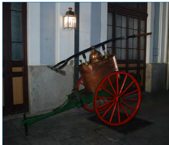
Figura 1. Bomba portable. En ella hay cobre (metal puro y aleaciones), hierro (forjado y acero) y polímeros (madera). Foto: JAMP 02/05/2018
