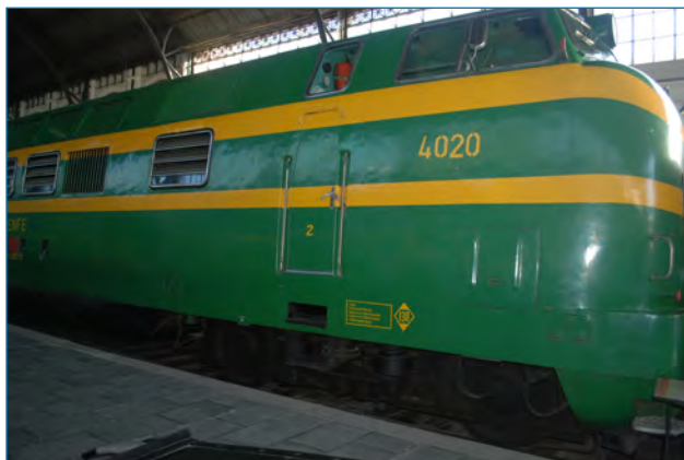
Figura 16. Locomotora 4020, diésel de 3030 CV. Se aprecia el boje delantero tipo “B” de 2 ejes. Foto: JAMP 02/05/2019
