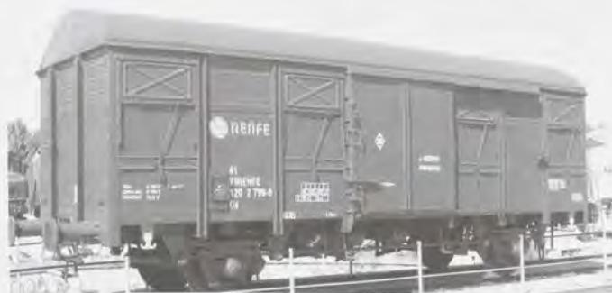
Vagón cerrado de tipo ordinario. En los orígenes del ferrocarril todos los vagones eran de este tipo. Salvo alguna rara excepción, todos estos primitivos vagones eran de dos ejes, construidos totalmente en madera, incluido el bastidor. A partir de 1880 el bastidor pasó a ser metálico, lo que permitió aumentar su capacidad de carga. Desde principios del siglo XX se empezó a utilizar la estructura de caja metálica, manteniéndose la madera en las paredes, piso y techo.
