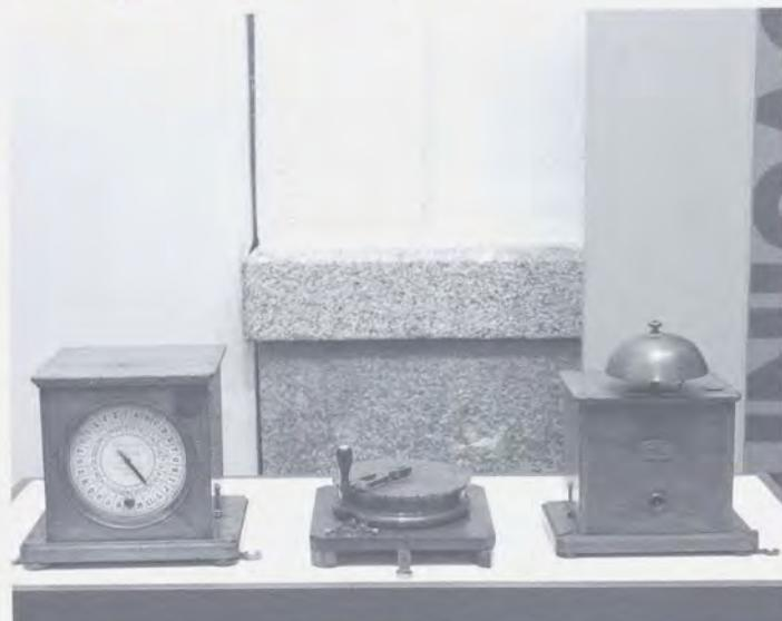
Nada menos que del año de aparición del ferrocarril en la Península (1848) data este aparato, imprescindible para asegurar y regular la circulación de los trenes en la época. El telégrafo, de madera y metal, se compone de tres piezas: transmisor, receptor y avisador de timbre. Estas dos últimas piezas están construidas por la fábrica francesa Maison Breguet, mientras que el transmisor proviene de la Sociedad Industrial de Teléfonos de París.
