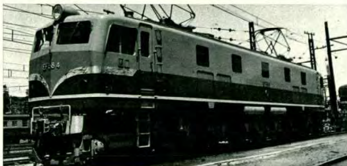
Locomotora eléctrica serie EF-58, tipo 2Co + Co2, para corriente continua 1.500 voltios. Potencia, 1.900 kilovatios, construida entre 1952 y 1958, para el remolque de grandes expresos.
