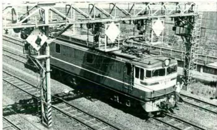
Locomotora eléctrica japonesa, serie EF60 tipo BBB.
