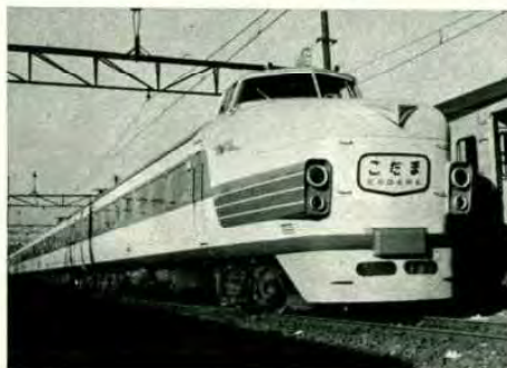
A pesar de la vía estrecha, los trenes japoneses alcanzan en ciertas líneas velocidades de más de 100 km/h., para cuyo remolque se empleaban locomotoras carenadas.
