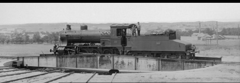
Locomotora de vapor nº 612 de la Compañía MCP, rodaje 040 sobre el nuevo puente-giratorio de Madrid-Delicias. Al fondo, el paseo de las Delicias y los edificios del Matadero de Ganados. Década de 1920.
