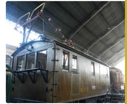
Locomotora Trifásica. Circulaban por los llamados "caminos del hierro" del sur de España al principio del siglo XX (20). Alcanzaba de 12 a 25 km/h.
